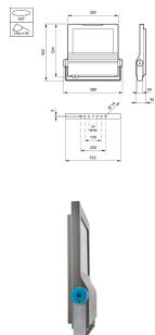
Technische Daten Philips Led-Scheinwerfer ClearFlood BVP650 Aluminium 205W 29240lm 72x22D - 740 Kaltweiß | IP66 - Symmetrisch
